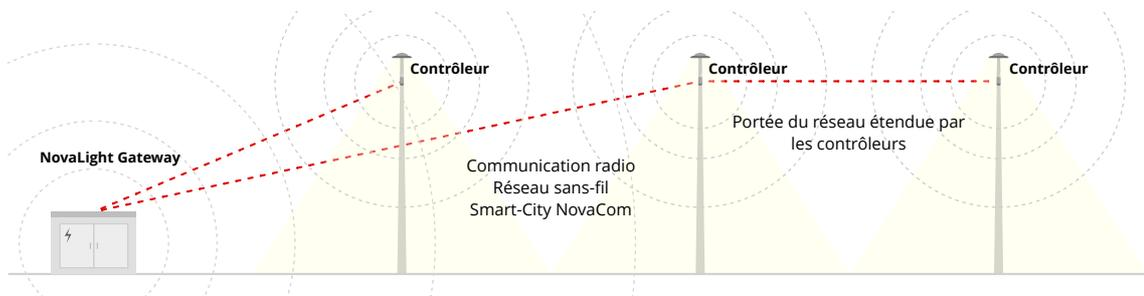
Une communication entre les contrôleurs s'exécute généralement en quelques dizaines de millisecondes. La profondeur du réseau – c'est-à-dire le nombre de contrôleurs intermédiaires permettant d'étendre la portée du réseau – est limitée à 15 sauts, ce qui veut dire qu'une seule NovaLight Gateway pourrait couvrir plus de 2.5km de distance avec son réseau pour une route longitudinale.
