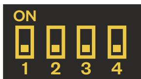
Le fonctionnement du radar Doppler peut être configuré en modifiant la combinaison des 4 interrupteurs DIP situé dans le port d'accès arrière du boîtier. Les interrupteurs ont deux positions, en direction des chiffres 1 à 4, représentant un état 0 ; ou en direction du sigle ON représentant un état actif. Les valeurs par défaut sont précisées ci-après. Pour modifier les
