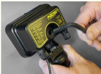
Retirer le cache en utilisant une clé imbus de 8mm afin d'accéder au sélecteur rotatif et aux interrupteurs DIP.
