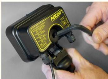
Entfernen Sie die Abdeckung mit einem 8-mm-Imbusschlüssel, um Zugang zum Drehschalter und den DIP-Schaltern zu erhalten.
