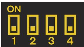
Der Betrieb des Radars kann durch Änderung der Kombination der 4 DIP-Schalter, die sich in der hinteren Zugangsöffnung des Gehäuses befinden, konfiguriert werden. Die Schalter haben zwei Stellungen: in Richtung der Ziffern 1 bis 4, was einem Zustand von 0 entspricht, oder in Richtung von ON, was einem aktiven Zustand entspricht. Die Standardwerte sind unten
