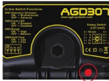
Die vordere LED blinkt 5 Mal und die hintere LED leuchtet für 1-2 Sekunden.
