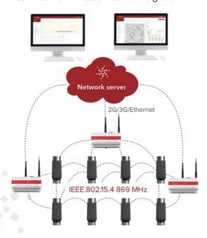
neusten Stand der Technik für das IIoT und arbeitet mit der Frequenz 868 MHz, welche eine hervorragende Leistung in Bezug auf Reichweite und Stromverbrauch bietet. Die Redundanz im Netzwerk ist hoch, da jedes Gerät Informationen an seine Nachbarn weiterleiten kann.
