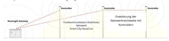
Eine Kommunikation zwischen den Controllern dauert in der Regel nur wenige zehn Millisekunden. Die Reichweite - d.h. die Anzahl der zwischengeschalteten Controller, mit denen die Reichweite des Netzwerks erweitert werden kann - ist auf 15 Sprünge (Hops) begrenzt. Das bedeutet, dass ein NovaLight Gateway Strecken von mehr als 2,5 km überbrücken kann.
