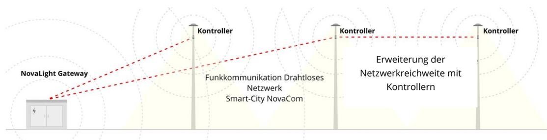
Eine Kommunikation zwischen den Controllern dauert in der Regel nur wenige zehn Millisekunden. Die Reichweite - d.h. die Anzahl der zwischengeschalteten Controller, mit denen die Reichweite des Netzwerks erweitert werden kann, ist auf 15 Sprünge (Hops) begrenzt. Das bedeutet, dass ein NovaLight Gateway Strecken von mehr als 2,5 km überbrücken kann.
