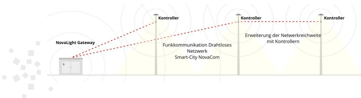
Die Kommunikation zwischen den Controllern dauert in der Regel nur wenige zehn Millisekunden. Die Netzwerktiefe - d.h. die Anzahl der zwischengeschalteten Controller, mit denen die Reichweite des Netzwerks erweitert wird - ist auf 15 Knoten beschränkt. Das bedeutet, dass ein einzelnes NovaLight Gateway eine Distanz von mehr als 2,5 km mit dem Netzwerk abdecken kann.
