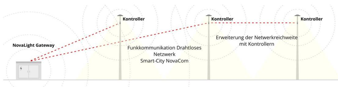
Die Kommunikation zwischen den Controllern dauert in der Regel nur wenige zehn Millisekunden. Die Netzwerktiefe, bzw. die Anzahl der zwischengeschalteten Controller, mit denen die Reichweite des Netzwerks erweitert wird, ist auf 15 Knoten (hops) beschränkt. Das bedeutet, dass ein einzelnes NovaLight Gateway eine Distanz von mehr als 2,5 km mit dem Netzwerk abdecken kann.
